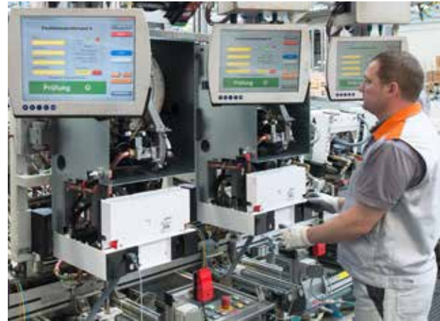
Prüfstand einer Fertigungslinie für Gas-Wandgeräte am Unternehmensstammsitz in Allendorf (Eder) Bildquelle: Viessmann Werke GmbH & CO. KG
